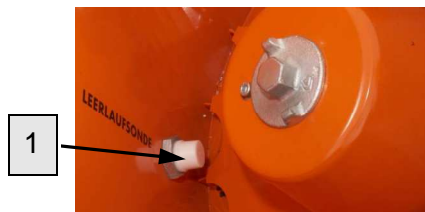
Fig. 28: Fill level sensor
